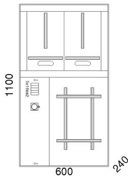
Einbau-Zählerkasten Nr. 2484.0
