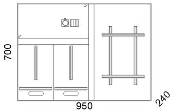
Einbau-Zählerkasten Nr. 2483.0
