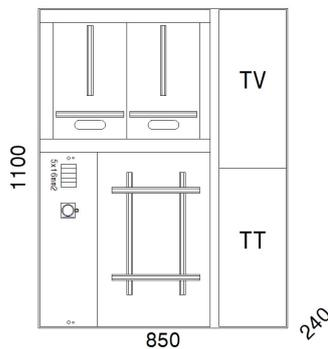
Einbau-Zählerkasten Nr. 2494.05
