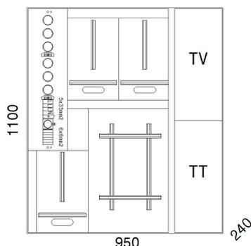
Einbau-Zählerkasten Nr. 2486.05
